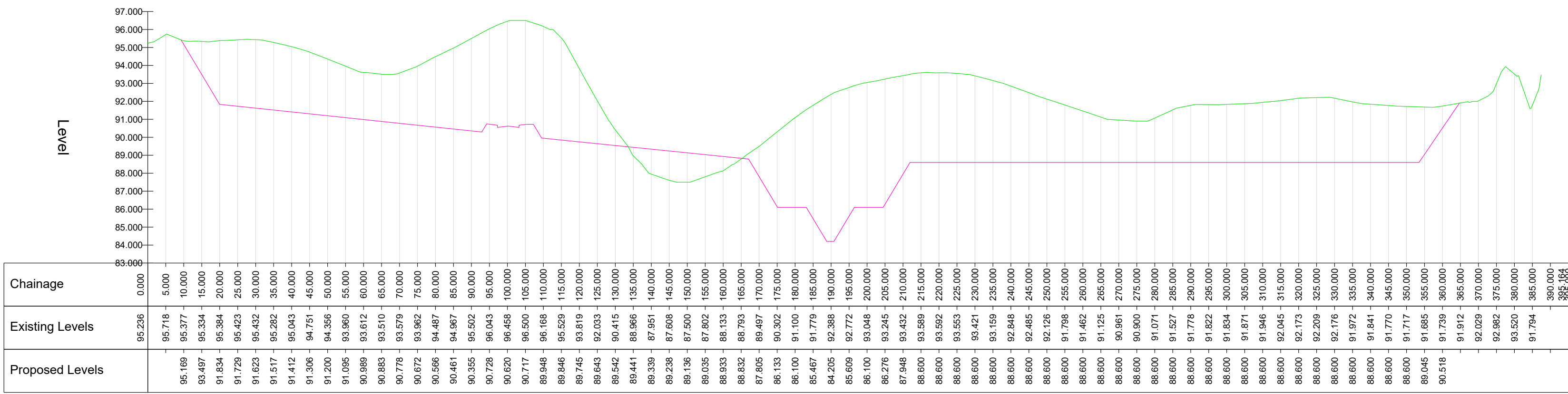
X-SECTION 4 - LONGSECTION SCALE: H 1:1000,V 1:200. DATUM: 83.000
